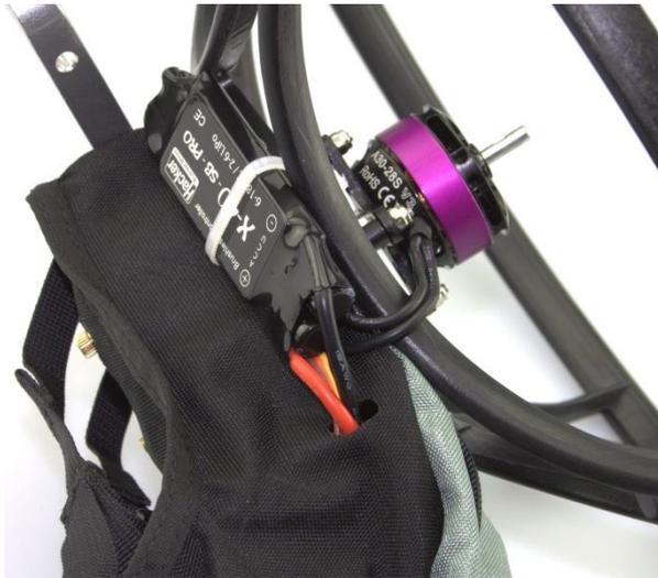
Der Steller ist befestigt, die Motorkabel sind sauber hinter der Steller geführt, Anschlusskabel für den Empfänger und den Akku sind durch den Ausschnitt in das Innere des Gurtzeugs gelegt. Wenn noch nicht geschehen, sollten jetzt die Steckverbinder am Steller angelötet werden.
