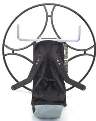
Wird der „Höhenruderknüppel“ nach hinten gezogen, werden beide Arme nach unten bewegt. Der gesamte Schirm wird angebremst. Diese Funktion ist nützlich um das Modell kurz vor der Landung abzufangen oder beim Thermikfliegen durch geringes Anbremsen zusätzlichen Auftrieb zu erzeugen. Tip: Landen Sie immer mit voll durchgezogenen (angebremsten) Armen um Beschädigungen der Servos zu verhindern.
