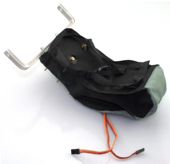
Das Gurtzeug kann nun komplett über den Sitz gestülpt werden. Die vier Schrauben für die Motorbefestigung sind dabei durch die entsprechenden Aussparungen im Gurtzeug geführt.
