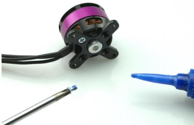
Das Montagekreuz wird mit den vier dem Motor beiliegenden Senkkopfschrauben mit dem Motor verschraubt. Verwenden Sie mittelfesten Schraubensicherungslack.
