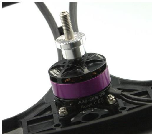
Um die Verletzungsgefahr durch einen versehentlich anlaufenden Motor beim Einstellen so gering wie möglich zu halten, sollte der Propeller erst zum Schluss montiert werden.
