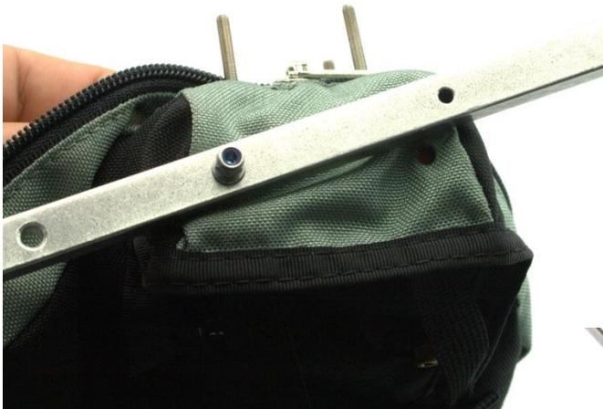
Dann wird der Alubügel positioniert und mit einer Unterlegscheibe und einer selbstsichernden Mutter fixiert. Ziehen Sie die Schraube nur leicht an, sodass sich der Bügel noch bewegen lässt. Gehen Sie mit der zweiten Schraube nun genauso vor.
