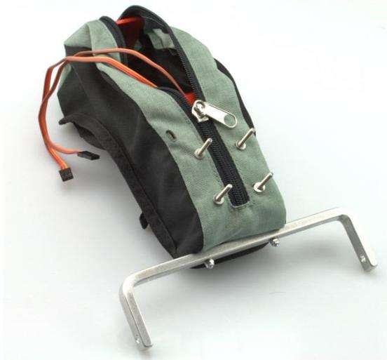
Der Reißverschluss wird etwas zugezogen und vier Beilagscheiben auf die Schrauben geschoben, anschließend wird der Prop-Käfig aufgesetzt.
