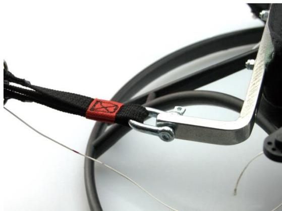
Der Gleitschirm wird mit den Schäkeln am Alubügel montiert. Es empfiehlt sich, die Schrauben der Schäkel von innen einzudrehen, andernfalls kann es beim Starten zu einem Verheddern der Bremsleinen kommen.
