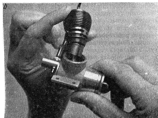
5-21. Najprostszy demontaż silnika (foto autora) a — odkręcenie cylindra za pomocą specjalnego klucza, b — wyjęcie cylindra
