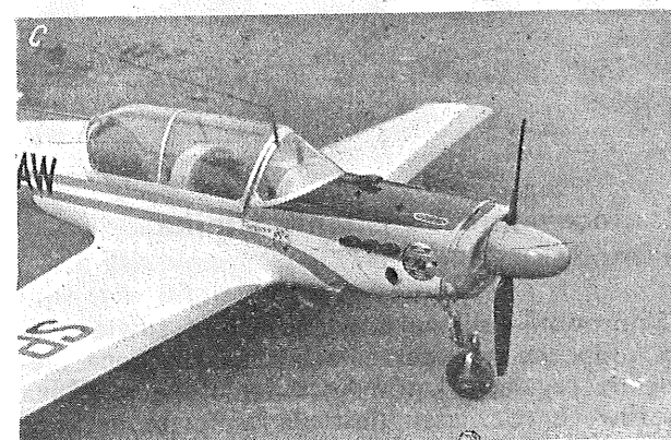
5-23. Różne sposoby zamocowania i oprofilowania silnika (foto autora)
