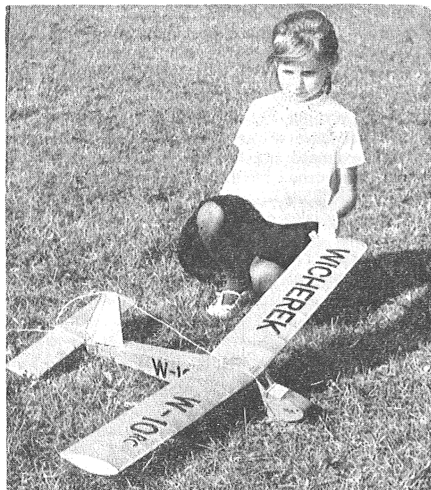
11-6. Miniaturowy WICHEREK 10RC jako szybowiec wyposażony w jednokanałową aparaturę amatorską (foto autora)
