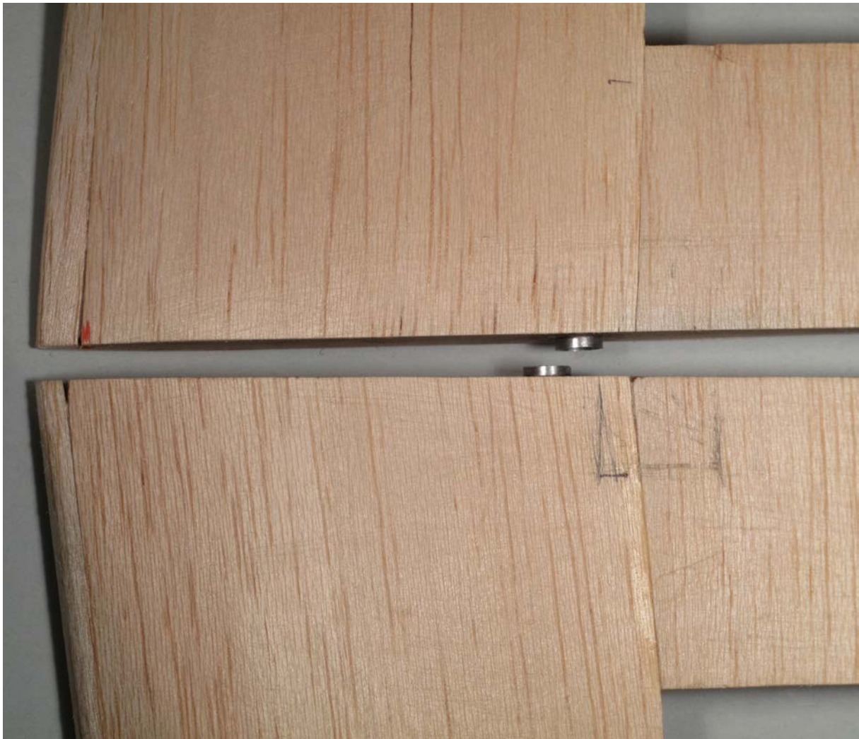
Fertige Leitwerkshälften mit leicht versetzten Aufnahmeröhrchen
