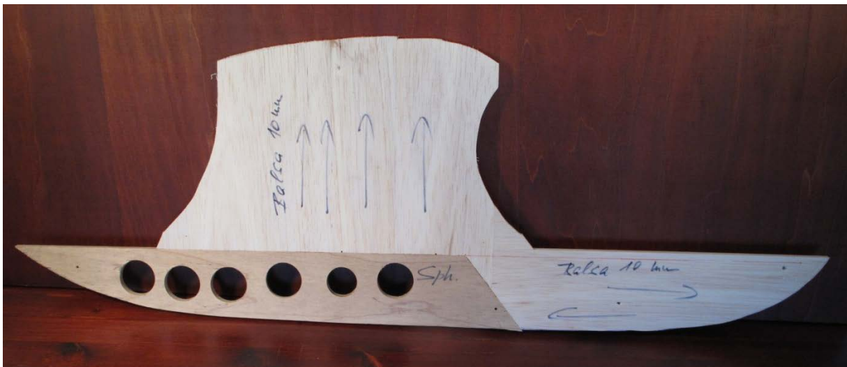
Der Kiel aus 10 mm Sperrholz und die Teile aus 10 mm Balsa – Maserung s. Pfeile.
