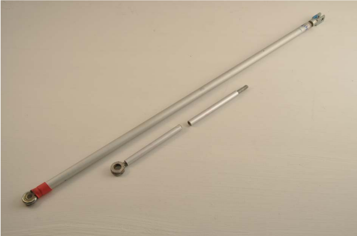
Eine Strebe fertig, davor die beiden Endstücke für die andere
