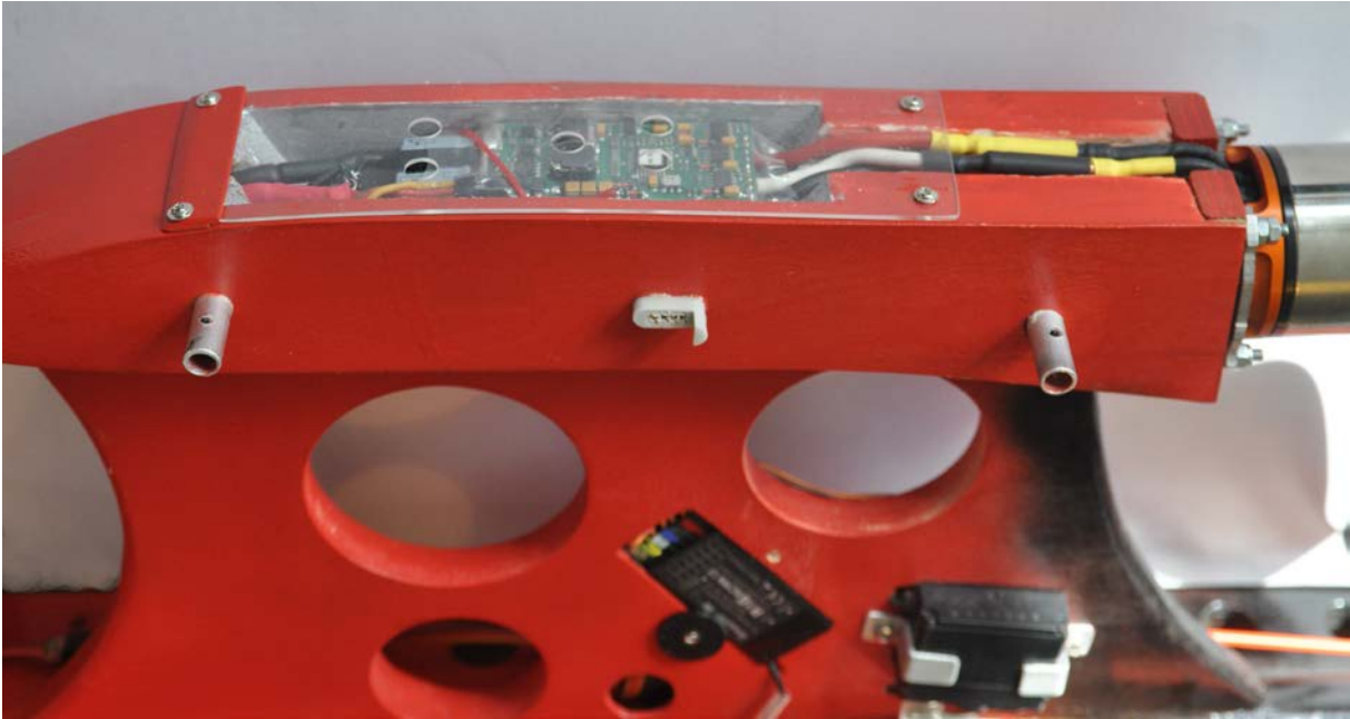
Der Reglerraum im fertigen Rumpf. Am Mittelstück die 8 mm Alurohre der Flügelsteckung und die Buchse für Anschluss des QR-Kabels
