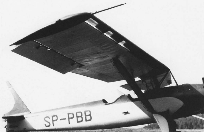
Prawe skrzydło, widoczne stałe skrzela i dajnik ciśnienia.
