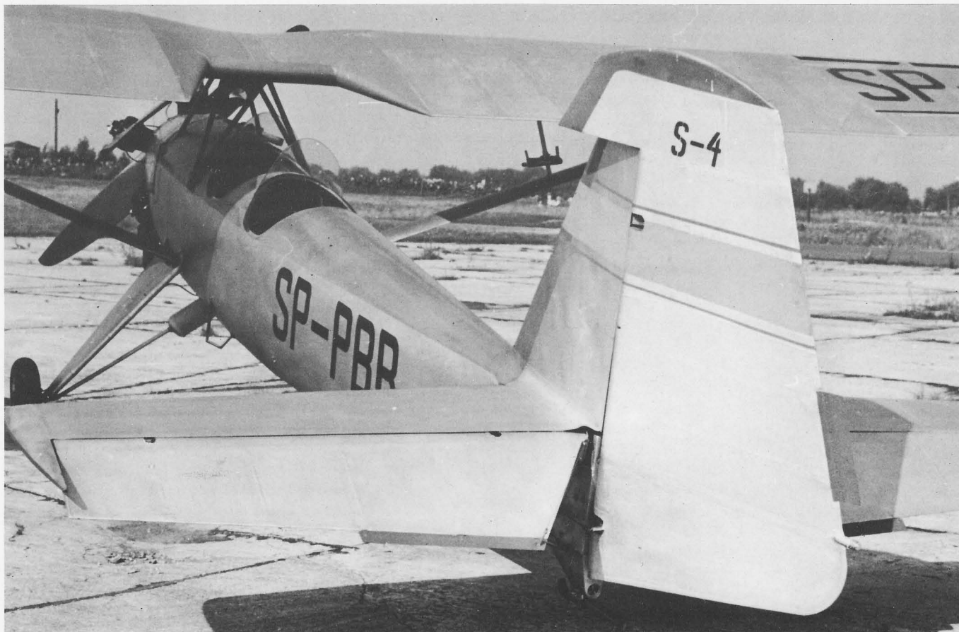
S-4 Kania 3, usterzenie samolotu. Malowanie z początkowego okresu eksploatacji i prób w Instytucie Lotnictwa
