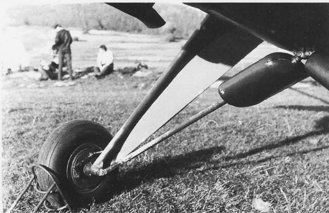
Fragment podwozia głównego samolotu Kania-3
