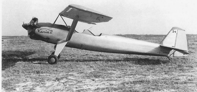
Kania 2 bez znaków rejestracyjnych z zimowymi osłonami na silniku i po zamontowaniu kłapek wyważających na sterach wysokości. Fot. J. Danel
