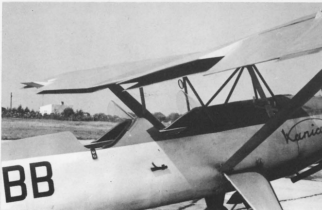
Kania 3, kłapy w położeniu startowym
