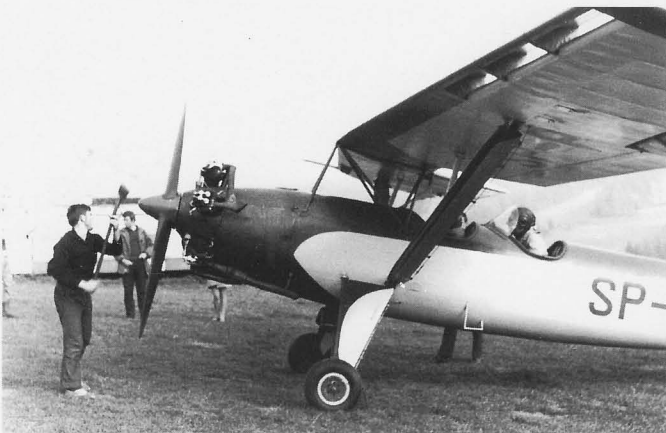
Uruchamianie silnika przy pomocy specjalnej łapki.
