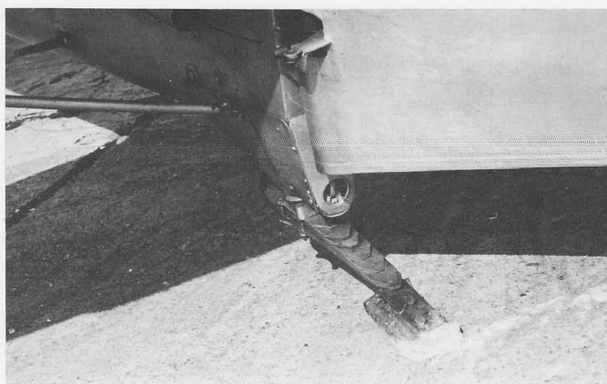
Kania 3 płozą ogonową i zaczep do holowania
