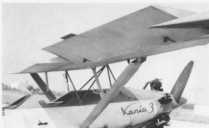
S-4 Kania 3 piramidka skrzydła i część lotkowa prawego skrzydła. Kłapkawyważająca lotki tylko na prawym skrzydła. Fot. Instr samolotu
