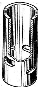
Фиг. 13. Гильза цилиндра мотора Ф-12 (см. фиг. 61).
