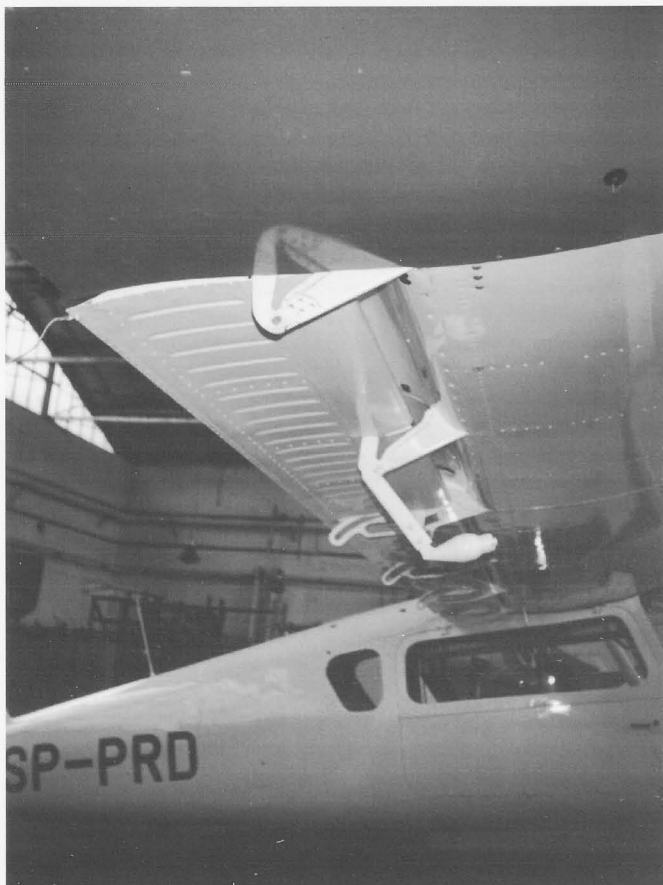
Zawieszenie prawej lotki, widoczne wyoblenia w pokryciu oraz ciężarek wyważający lotki.
