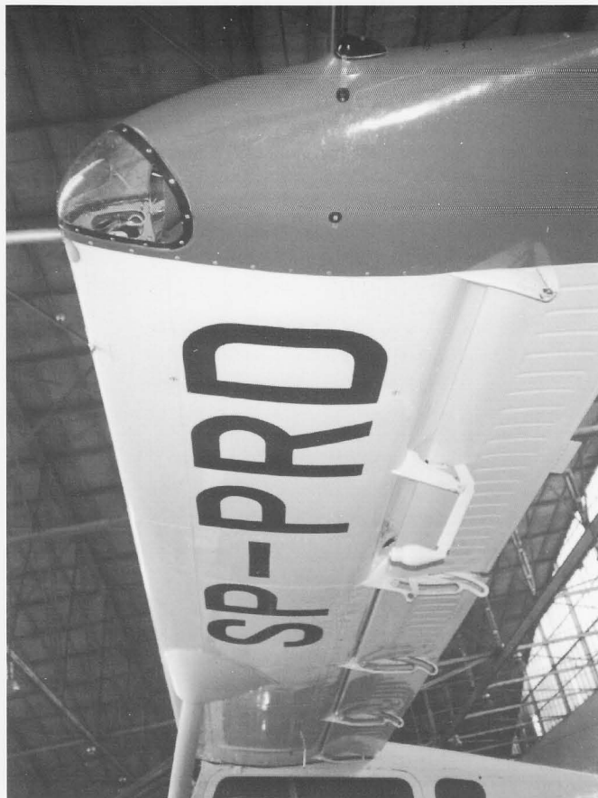
Lewe skrzydło widziane od dołu. W końcówce reflektor do lądowania w nocy. Widoczna osłona mocowania zastrzału oraz prowadnice klap.
