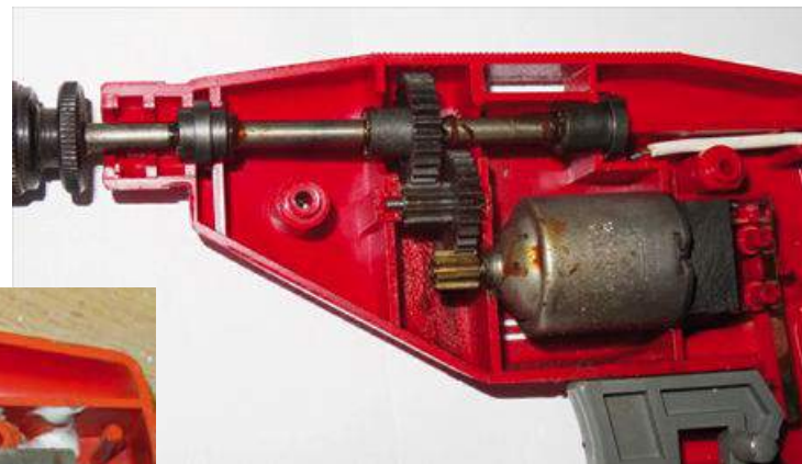
Motor, Welle und Bohrfutter konnten nicht überzeugen ...
