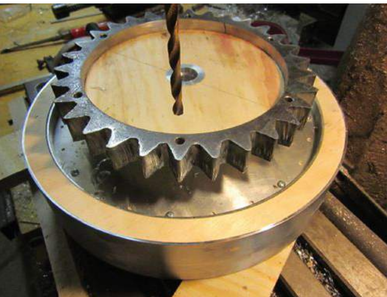
Das mit einer Sperrholzschaablone zentrierte Zahnrad
