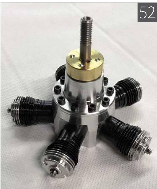
5-Zylinder-Sternmotor aus Cox-Zweitaktern
