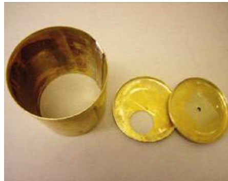
Kesselrohr mit unterlegter Naht, Boden „Hinten“ und „Vorne“
