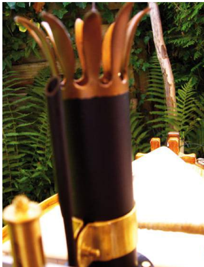
Kamin mit „goldenen Federn“, die Bride für das Abdampfrohr und die Dampfpeife
