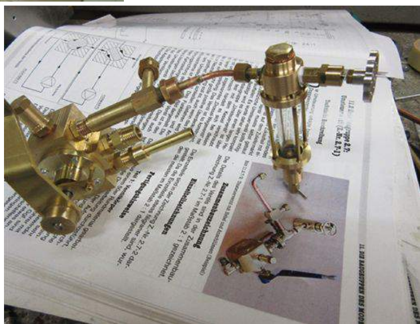
Umsteuerventil mit selbst gebautem Öler
