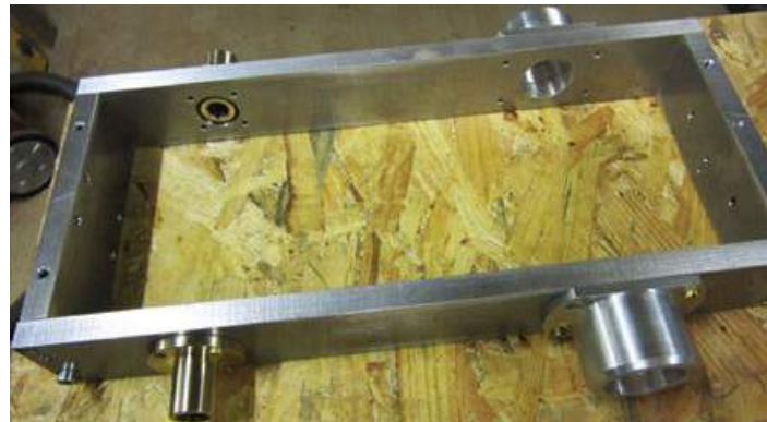
Der Motorträger: links die Schwenklager, rechts die Achslager
