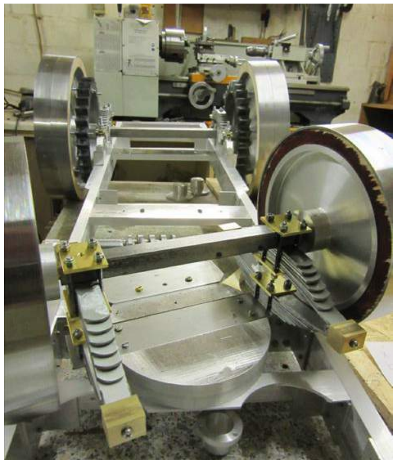
Das Zahnrad an seinem Platz, innerer Ring und Radreifen sind auch eingebaut
