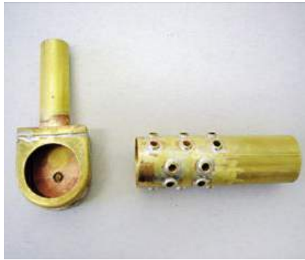
Rauchkammer mit Innenkamin, Flammrohr mit Siederohren
