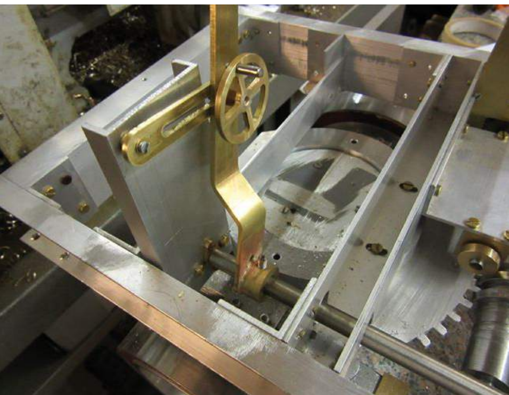
Die neue Halterung des Schalthebels
