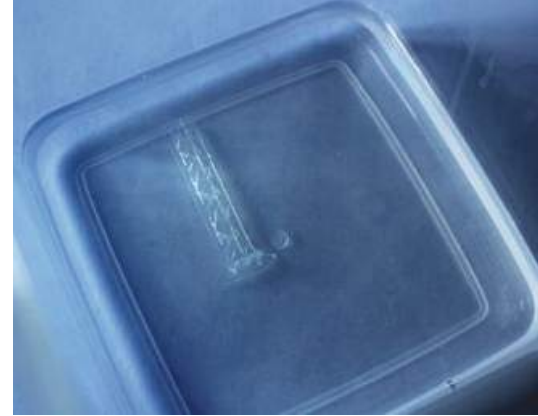
Spülen des Druckteils in Alkohol
