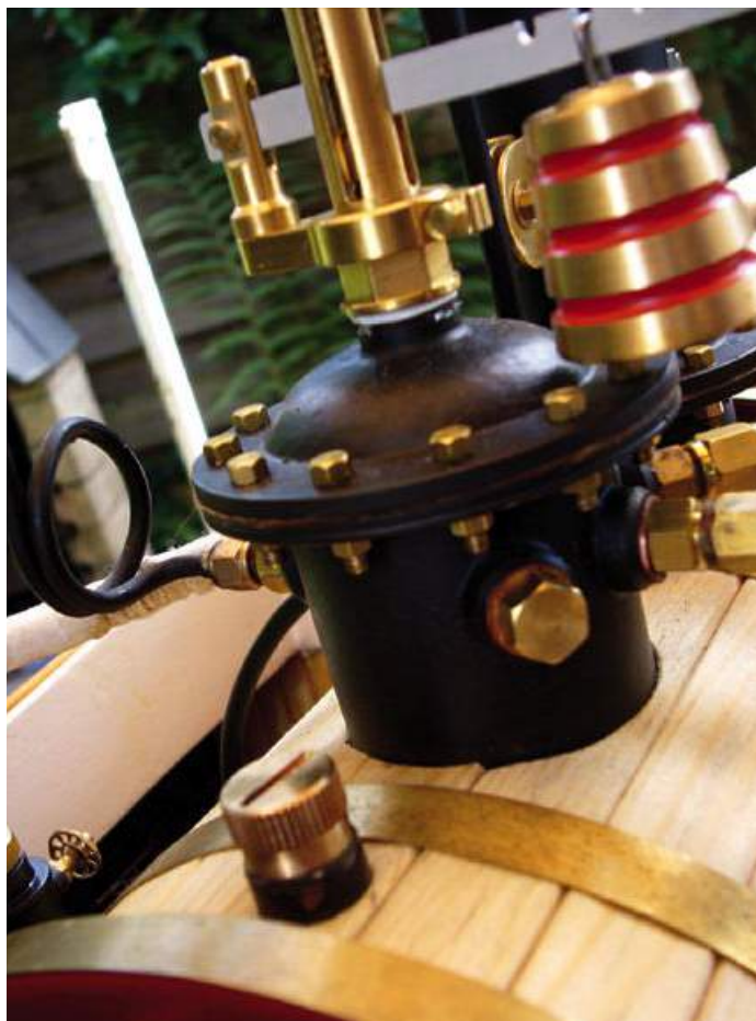
Dampfdom mit dem Sicherheitsventil, Vorne: Einfüllstelle
