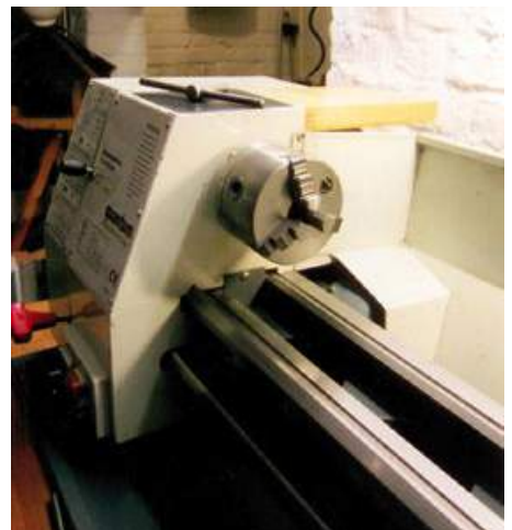
Die Werkzeugablage aus Holz. Der Ein-Aus-Schalter wurde nach unten verlegt
