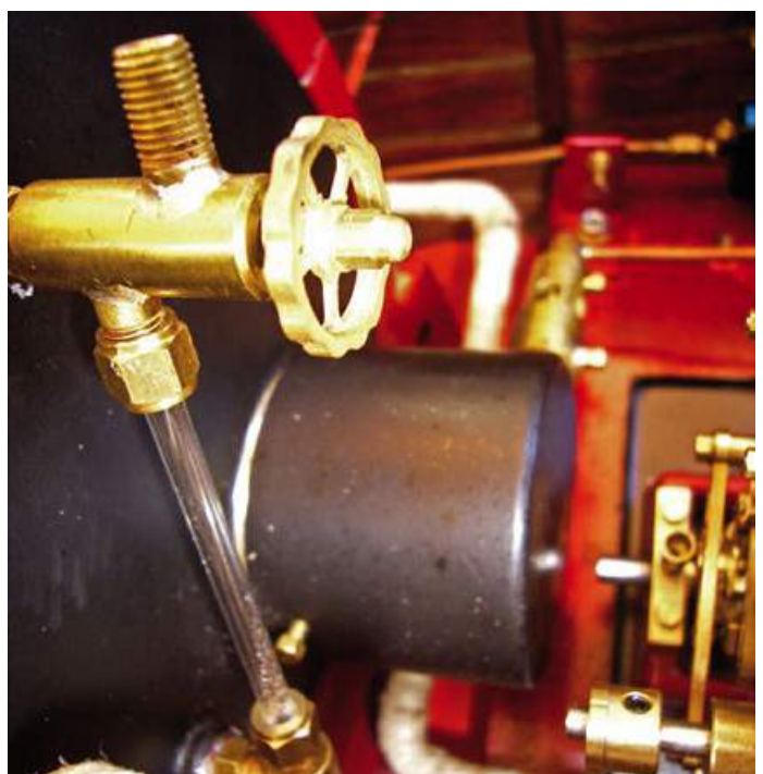
Wasserstand mit Entlüftung vor dem Brenner
