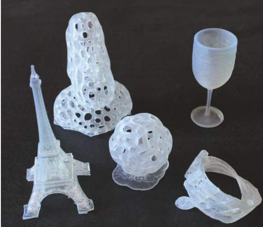
Feine Details sind im SLA-Verfahren möglich
