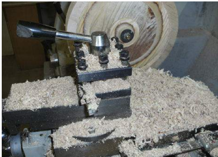
Ein Holzrad wird bearbeitet
