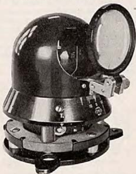
Rys. 13. Amortyzacja busoli O.M.I.
