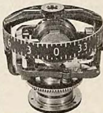
Rys. 141. Mechanizm żyroskopowego wskaźnika kursu Sperry
