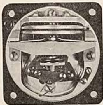
Rys. 69. Mechanizm wysokościomierza G. Gerlach
