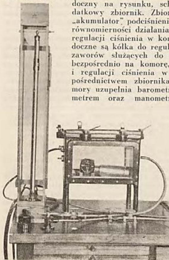
Rys .76b. Komora próżniowa firmy Askania
