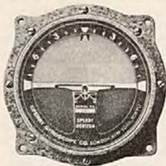
Rys. 132. Sztuczny horyzont Sperry
