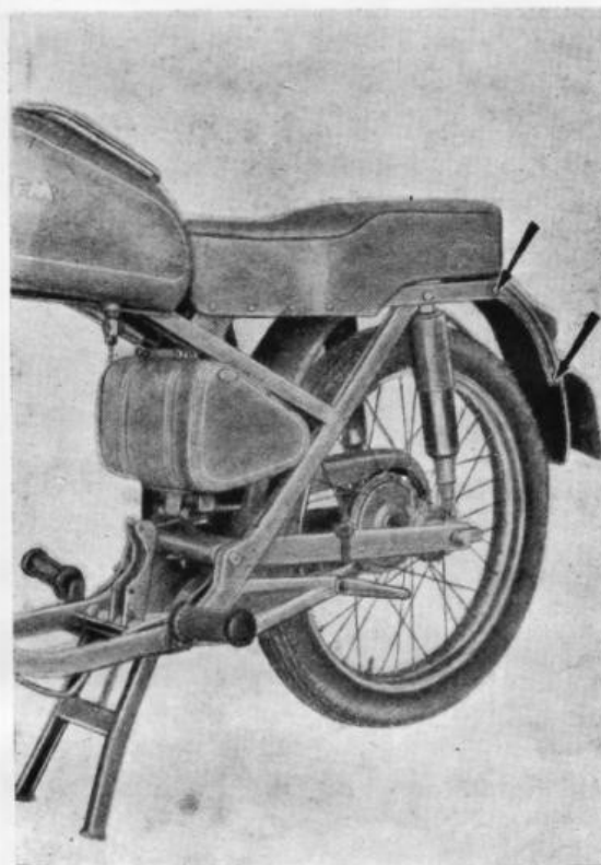
Rys. 152. Demontaż błotnika tylnego I
