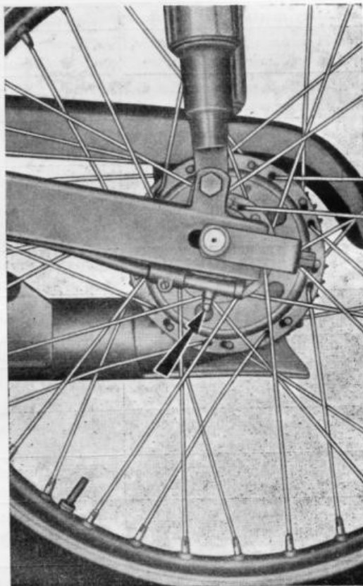
Rys. 76. Smarowanie napędu szybkościomierza
