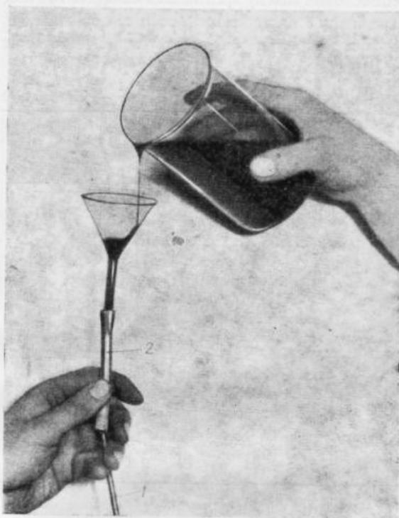
Rys. 82. Smarowanie cięgiel Bowdena
