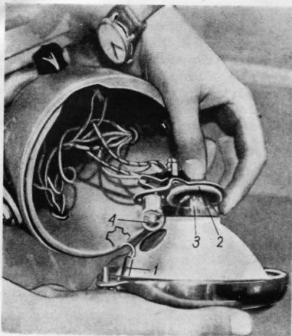
Rys. 186. Wymiana żarówek lampy przedniej
