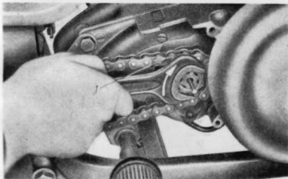
Rys. 28. Odkręcanie nakrętki zdawczego koła łańcuchowego
