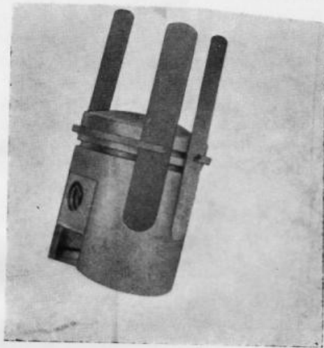
Rys. 49. Zdejmowanie pierścieni tłokowych
