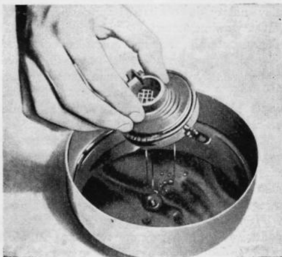
Rys. 11. Mycie filtra powietrza
