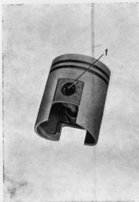
Rys. 47. Wyjmowanie pierścieni zabezpieczających sworzni tłokowy
