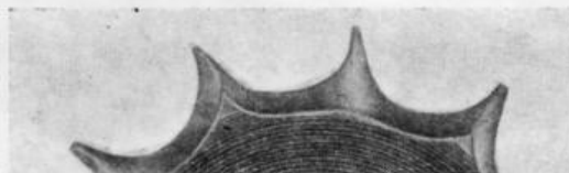
Rys. 160. Profil zużytych zębów zębatego koła łańcuchowej.
