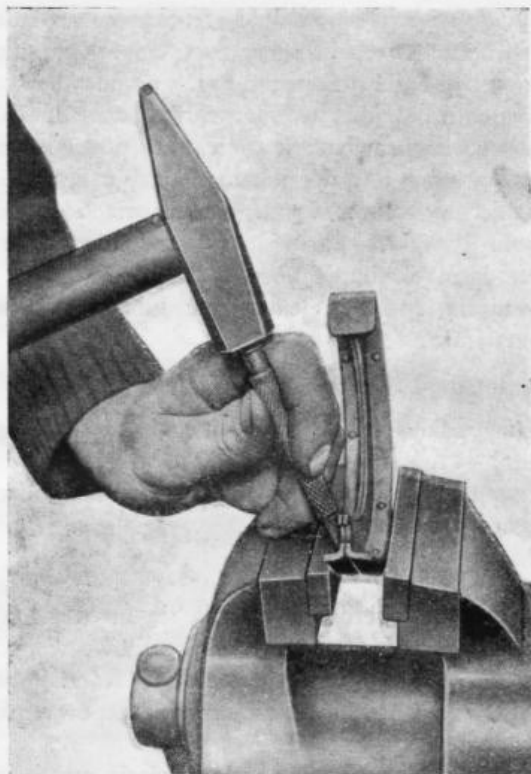
Rys. 161. Naprawa szczęk hamulca
