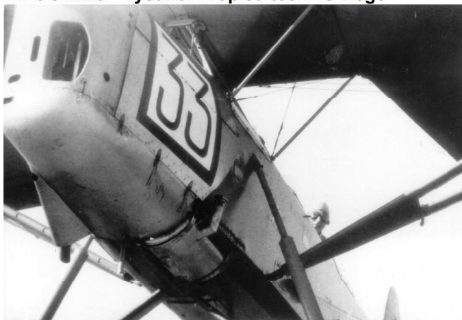
Osłona silnika RWD-8pws. Widoczna pojedyncza rura wydechowa, odprowadzająca spaliny ze wszystkich cylindrów. Obok niej zbiornik oleju.
