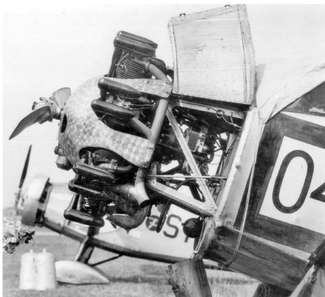
Częściowo widoczne łożo silnika
