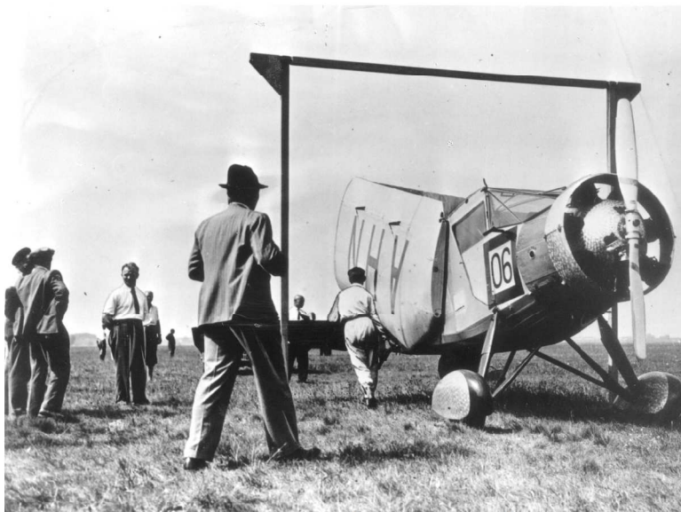
Sprawdzenie, czy samolot mieści się w określonej skrajni. Widać szczegóły mocowania skrzydło-kałdub
