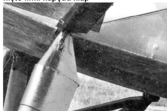
Rozpinane mocowanie dolnego końca zastrzału oraz goleni podwozia. Na zastrzale widoczna blaszka obejmująca przetyczkę sworznia
