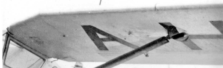
Owiewka mocowania zastrzału do kałduba posiadała nacięcie, umożliwiające obrót zastrzału po rozpięciu dolnego sworznia. Naoryginale można też dopatrzeć się okucia, prawdopodobnie umożliwiającego mocowanie zastrzału do skrzydła (po złożeniu)
