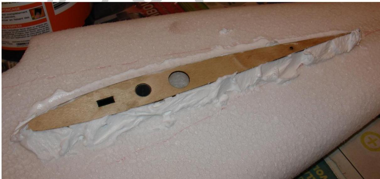
Former le karman avec un tube humidifié. Le surplus d'enduit s'enroule autour du tube et est donc facile à retirer.
