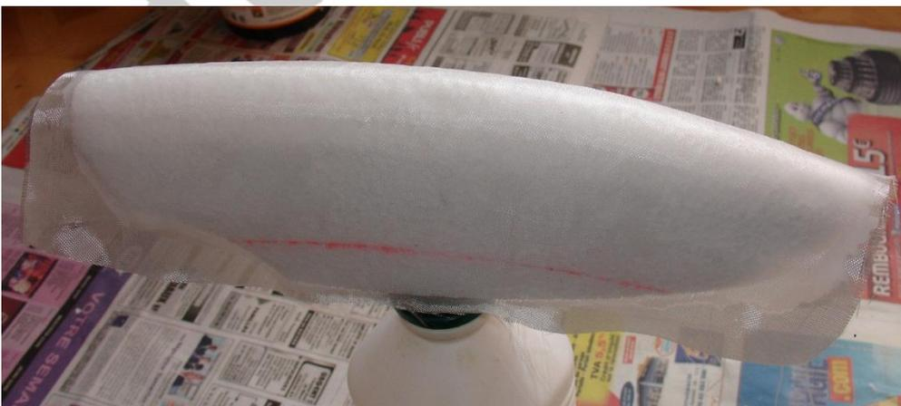
Environ quinze minutes plus tard la colle est suffisamment sèche pour pouvoir y revenir. Araser le tissu sur les bords, il se découpe aux ciseaux comme du papier. Toujours avec la même préparation, remouiller les cloques et re-plaquer les bords au besoin. L'alcool à brûler de la préparation redissout la colle et la réactive : on peut revenir sur son travail autant qu'on veut.
