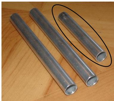
Préparer ensuite le tronçon central de l'aile qui sera solidaire du fuselage. Sortir le tronçon de 60mm de long de tube alu  $\varnothing 9-8$  ; les deux autres tronçons, plus longs, serviront plus tard pour les ailes.
