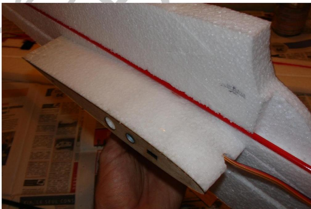
L'enfoncer ensuite pour le centrer à peu près. Avec cette manière de procéder on est assurés qu'il y a bien de la colle à l'interface fuselage/tronçon central et il n'y a pas de risque d'en mettre sur les nervures.
