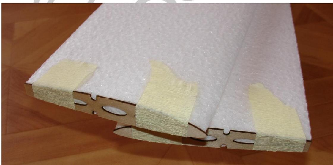
Fraiser les logement des longerons (fraise  $\varnothing 3\text{mm}$ , profondeur 3mm) à l'intrados et à l'extrados. Des encoches sont pratiquées dans les nervures pour le longeron, les utiliser comme repères pour positionner un guide pour le fraisage.
