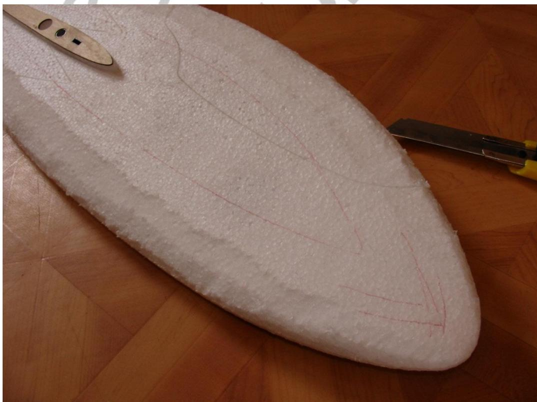
Finalement terminer la mise en forme par ponçage avec du papier de verre grain 120 ou plus épais.
