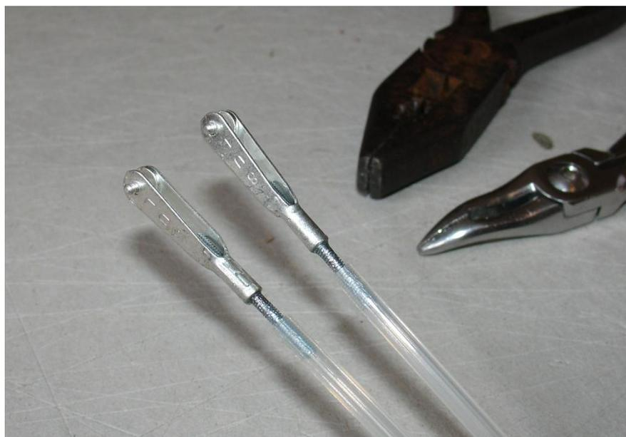
Recouper les gaines de commande à 35mm des palonniers servos à l'avant et à 35mm des guignols de l'empennage à l'arrière.
