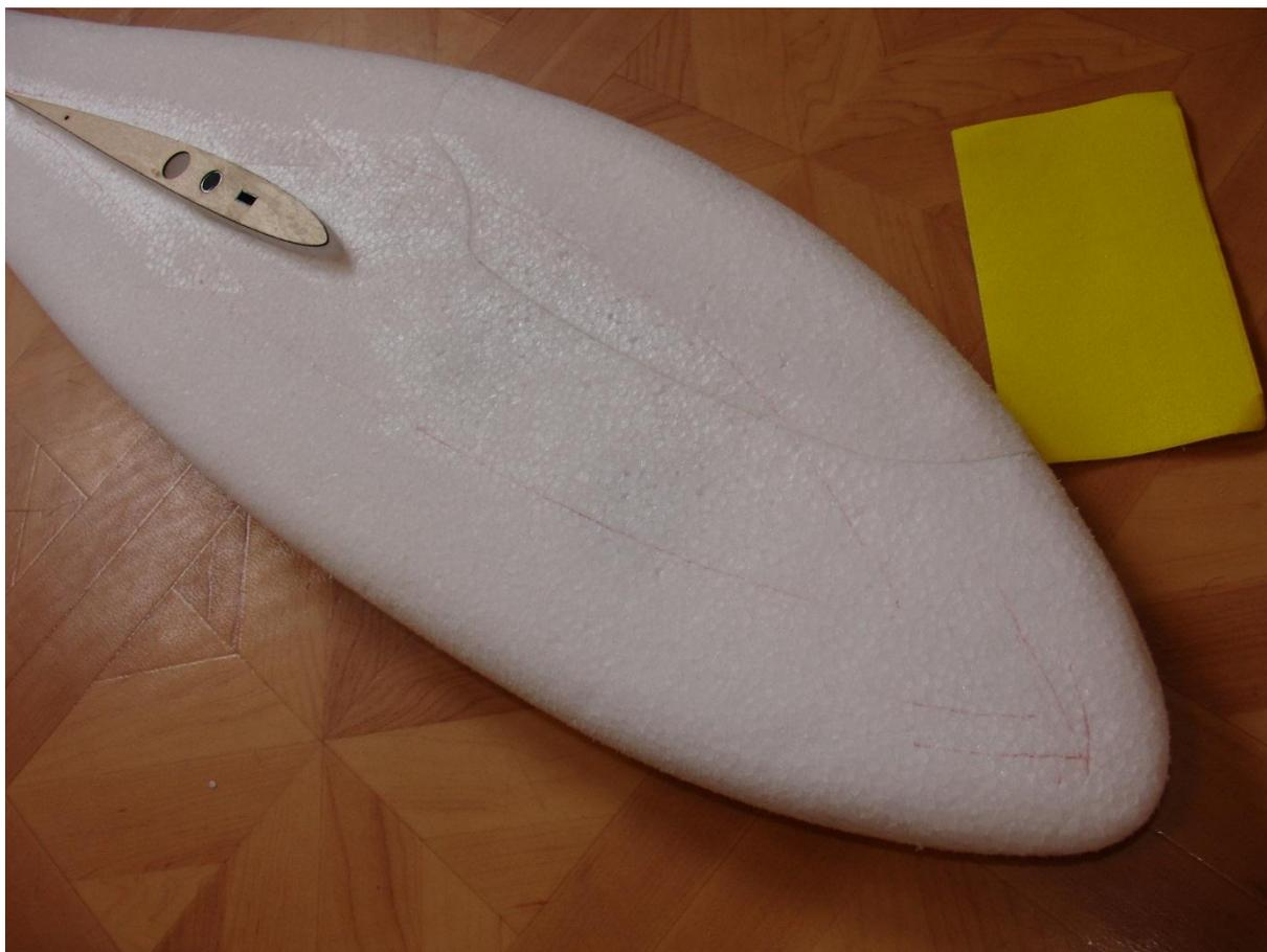
Pour l'esthétique et pour faciliter l'entoilage à la jonction tronçon central/fuselage il es préférable de réaliser un karman. Pour celà, commencer par enduire abondamment cette zone avec de l'enduit ultralight.
