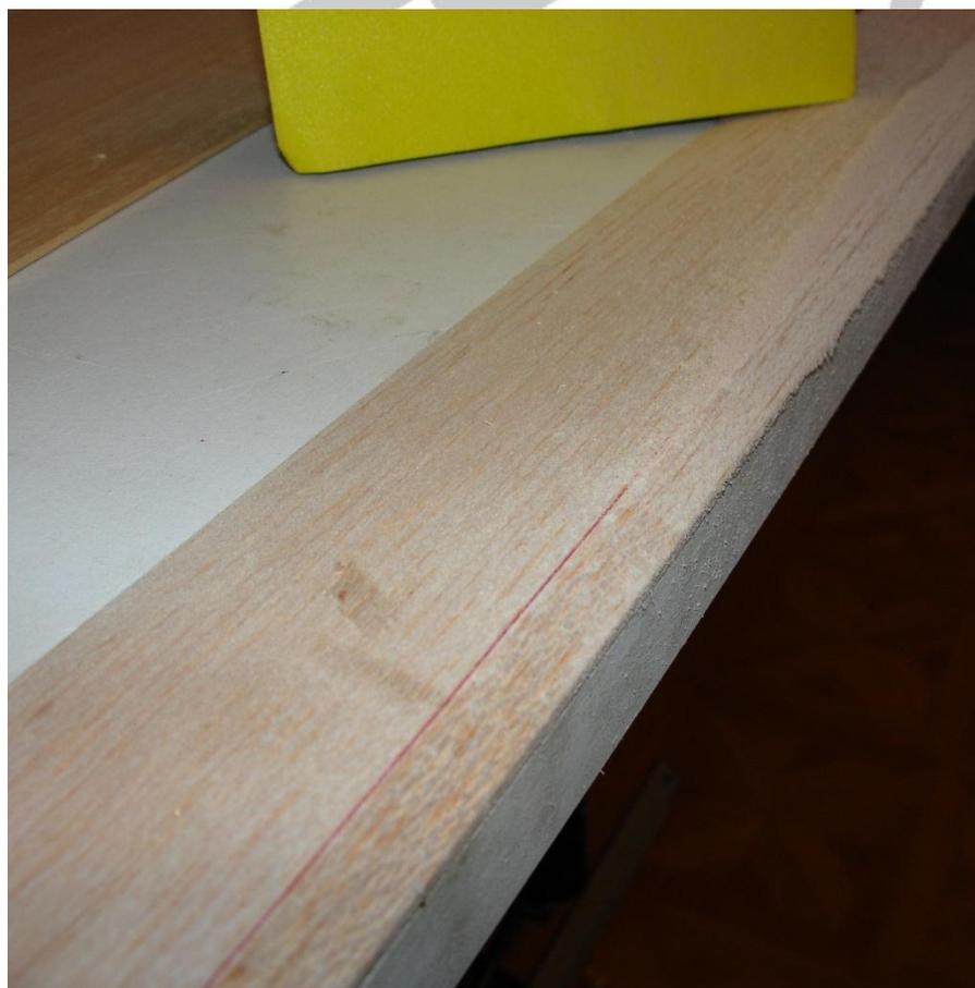
Pour finir poncer le bord d'attaque à 40° environ pour permettre à l'aileron de débattre. Ce travail pourra être ébauché au rabot pour gagner du temps.
