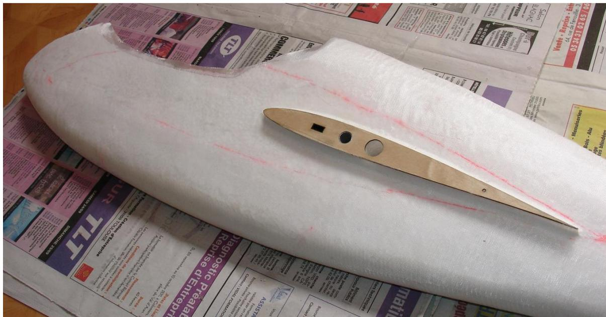
Environ quinze minutes plus tard, revenir sur d'éventuelles cloques. Si du tissu dépasse dessus et dessous, l'araser un peu avant le plan de joint. Poser ensuite les bandes de 50mm de large pour joindre l'entoilage des deux côtés.
