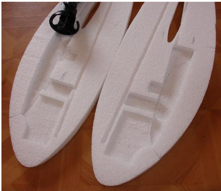
Percer enfin les sorties de gaine de commande avec un tube  $\varnothing 5\text{mm}$  affuté ou avec une fraise. Adoucir l'angle de sortie côté intérieur en limant avec une lime queue de rat ou en fraisant à main levée. Respecter autant que possible les côtes indiquées ci dessous pour un fonctionnement sans point dur.
