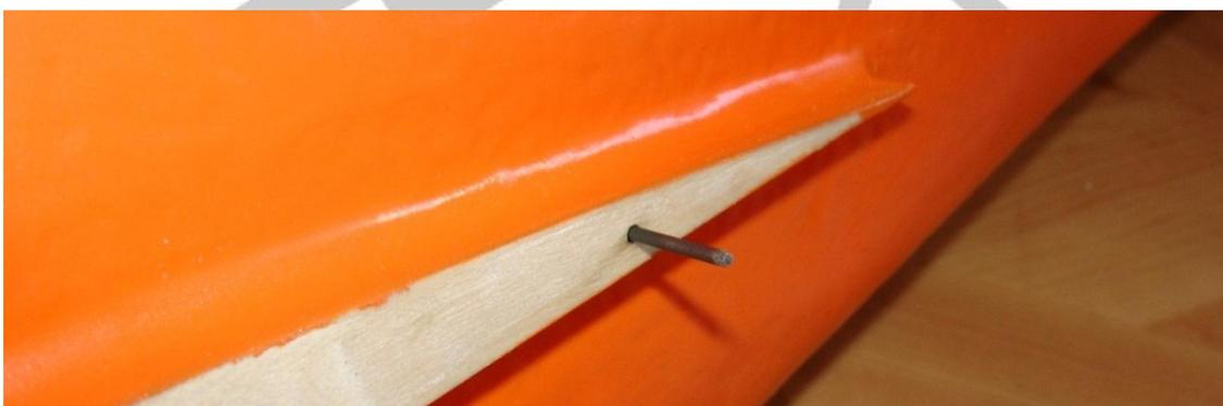
Les ailes seront maintenues en place par un élastique. Il est inutile d'employer un élastique fort. Passer une chute de tringle plastique dans l'élastique de chaque côté du fuselage lors du stockage. Cette tige est aussi très pratique pour passer l'élastique dans le crochet de l'aile lors du montage.
