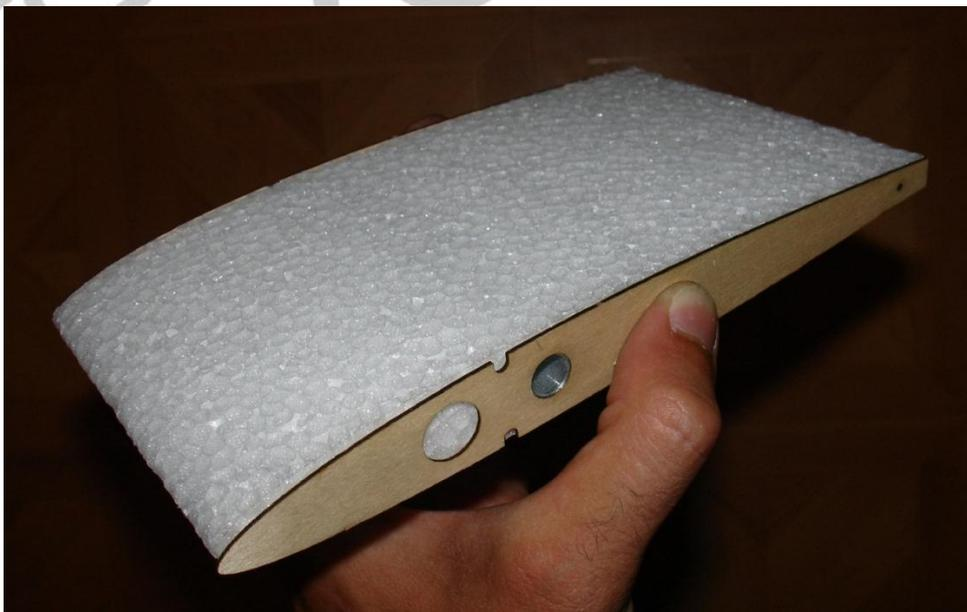
Une fois l'ajustement correct retirer les nervures. Ouvrir légèrement le panneau, comme sur la photo, et insérer de la colle polyuréthane dans la fente. Tourner le fourreau pour bien répartir la colle.
