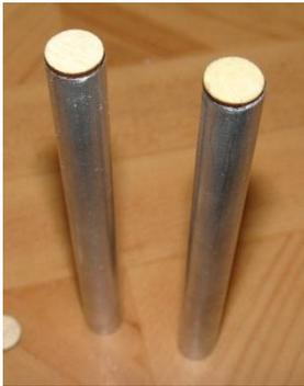
Pour éviter que la clé d'aile ne perce l'EPP en bout de fourreau, boucher ces derniers d'un côté en collant à l'époxy cinq minutes les pastilles en contreplaqué.
