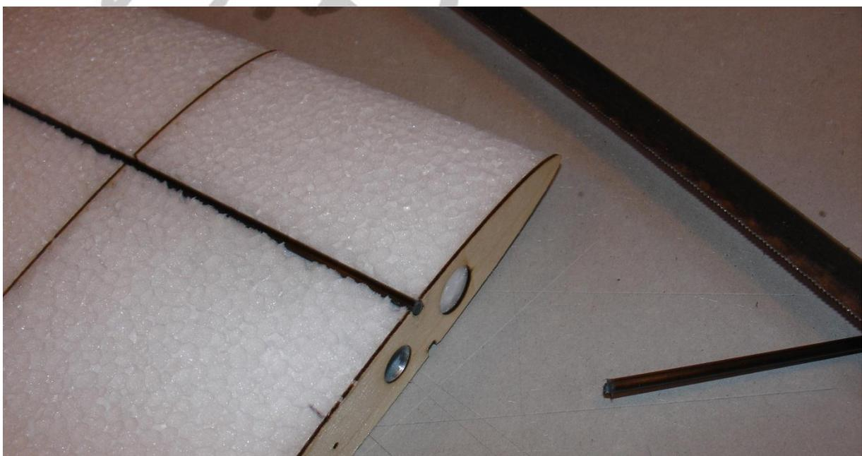
Positionner les ailes sur une surface plane et coller les longerons à la colle polyuréthane. Coller d'abord le longeron d'Extrados puis dans un second temps le longeron d'Intrados. Disposer des poids sur le longeron sans quoi le gonflement de la colle pourrait le sortir de son logement ; intercaler des cales pour ne pas marquer l'aile. Pour éviter que les cales ne restent collées, les recouvrir de scotch d'emballage.
