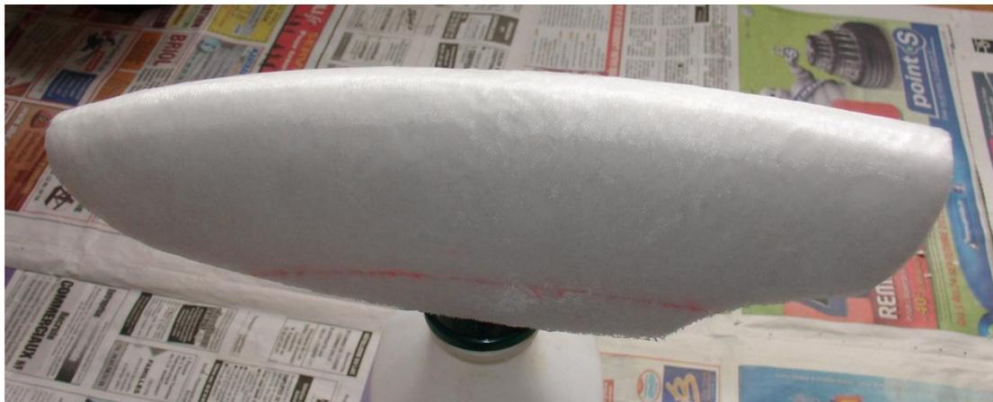
Procéder de la même manière pour le fuselage, côté par côté. Au niveau du karman et des sorties de commande pratiquer une fente dans les coupes de fibre.
