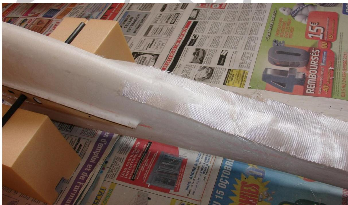
Une fois la colle parfaitement sèche placer quelques plots d'enduit Ultralight sur le fuselage et l'étaler à la main. Le but est d'en mettre le moins possible, il faut simplement boucher les creux et atténuer les jonctions des coupons de fibre. Effectuer en parallèle ces étapes de finition sur la bulle.
