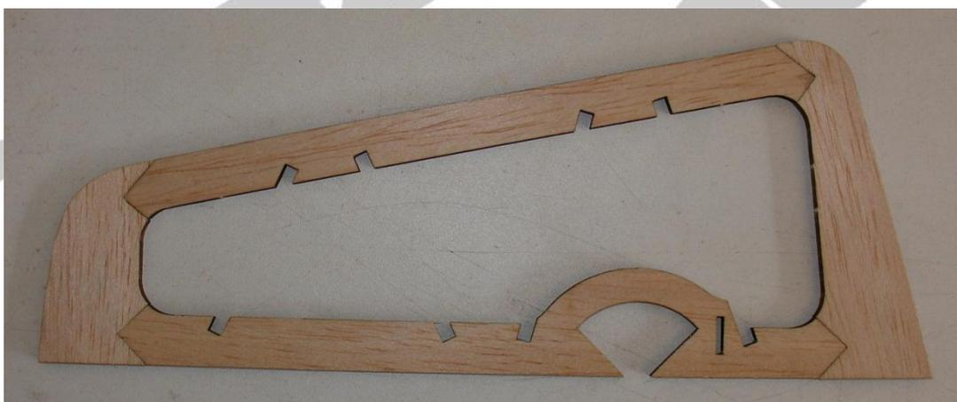
Tailler dans la baguette de balsa 4x4 les croisillons du volet de dérive et les mettre en place. Les coller par infiltration de colle cyanoacrylate liquide.
