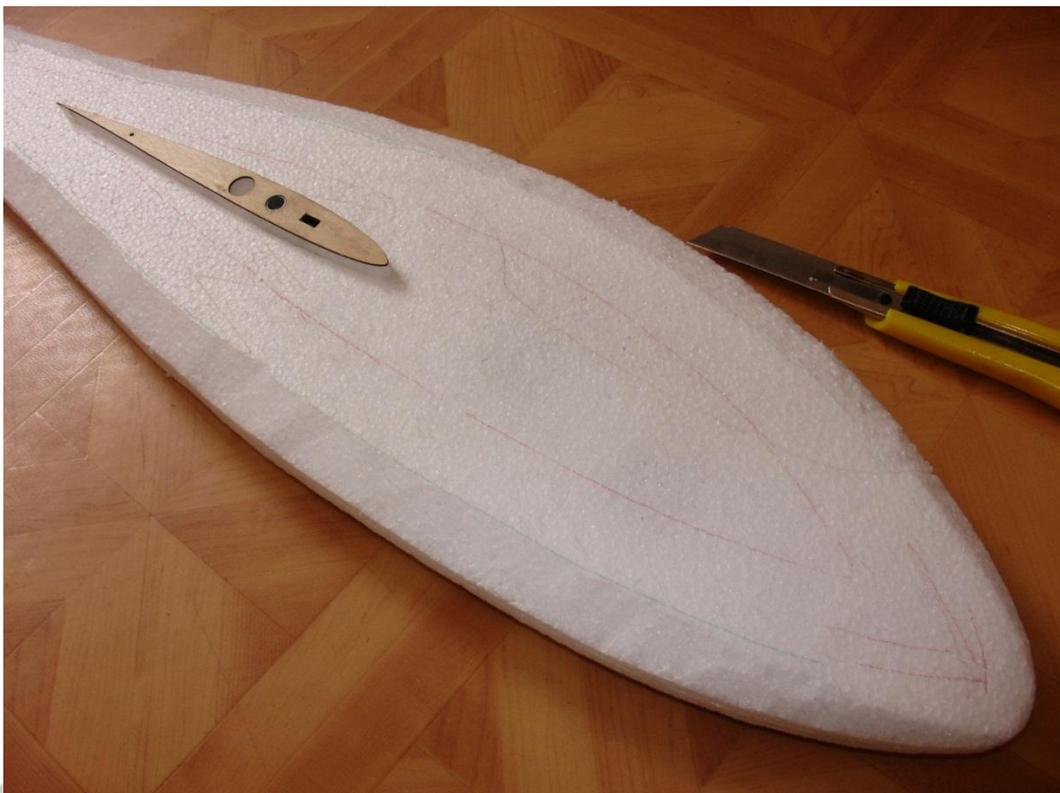
Tailler des facettes sur les arêtes formées par la découpe précédente en essayant d'approcher une section elliptique. Renouveler l'opération jusqu'à arriver quasiment à la forme désirée.
