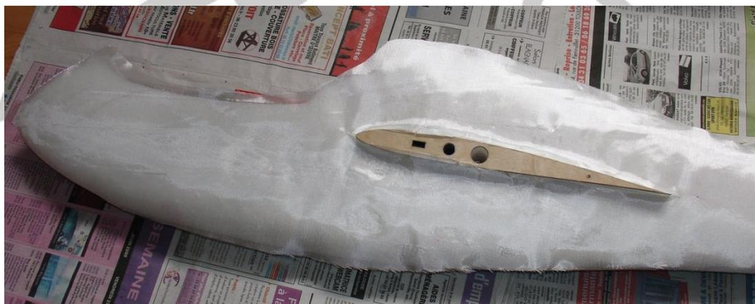
Une fois le tissu bien positionné mouiller une première bande au milieu du fuselage pour l'immobiliser.
