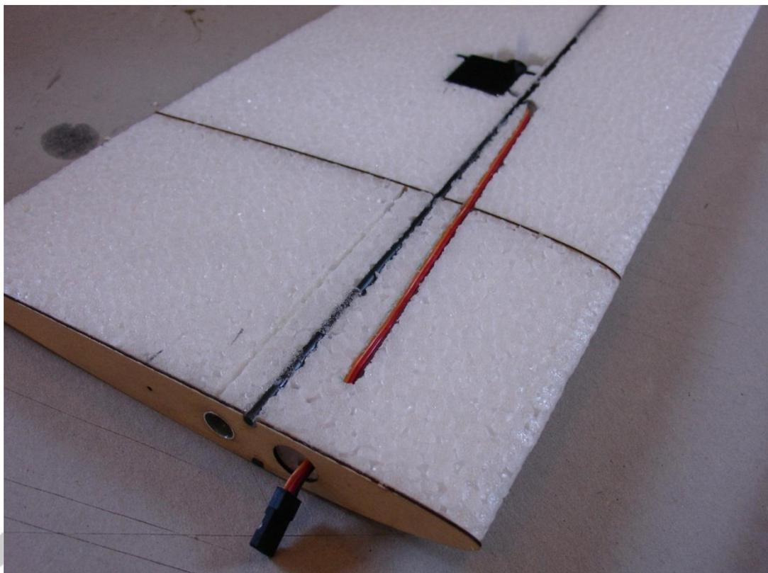
Finalement, mastiquer la saignée à l'enduit ultralight. Reboucher en même temps le reste de rainure du fourreau de clé.
