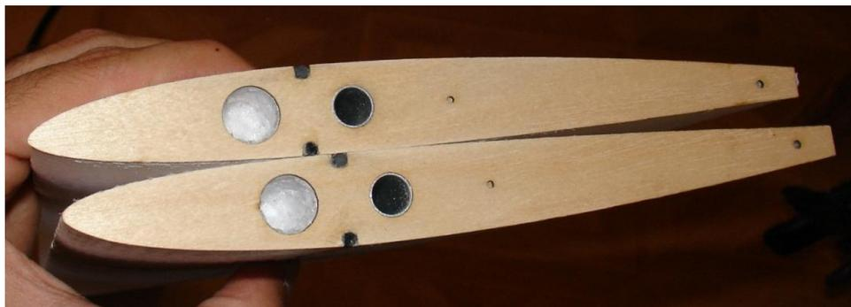
Fraiser le logement du servo en suivant le tracé. Le fil servo passe entre les longerons puis dans une saignée qui l'amène au bout du trou dans l'EPP à l'emplanture. Fraiser la saignée à une profondeur d'environ 2mm.
