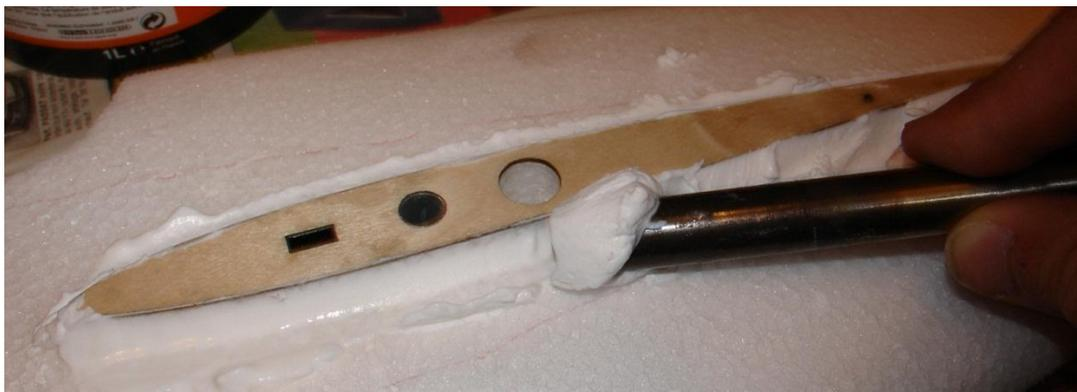
Finalement avec une cale plate retirer les bavures du fuselage.
