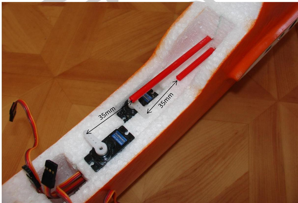
Insérer les tringles de commande par l'arrière et clipser les chapes aux guignols de l'empennage. Bloquer les gouvernes de l'empennage au neutre et tracer un repère sur les tringles à 28mm du palonnier de servo. Démonter les tringles et les recouper au niveau du repère. Visser les deux
