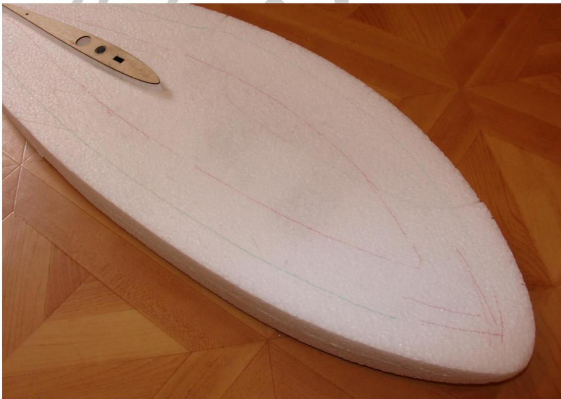
Au cutter, tailler une première facette à 45° sans trop s'approcher de la ligne de jonction des deux côtés du fuselage.
