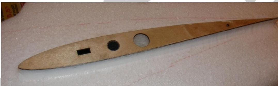
Decouper des coupons de fibre de verre 50g/m<sup>2</sup> pour l'entoilage du fuselage : un pour chaque côté, sans marge, deux bandes de 50mm de large et une pièce pour la bulle.
