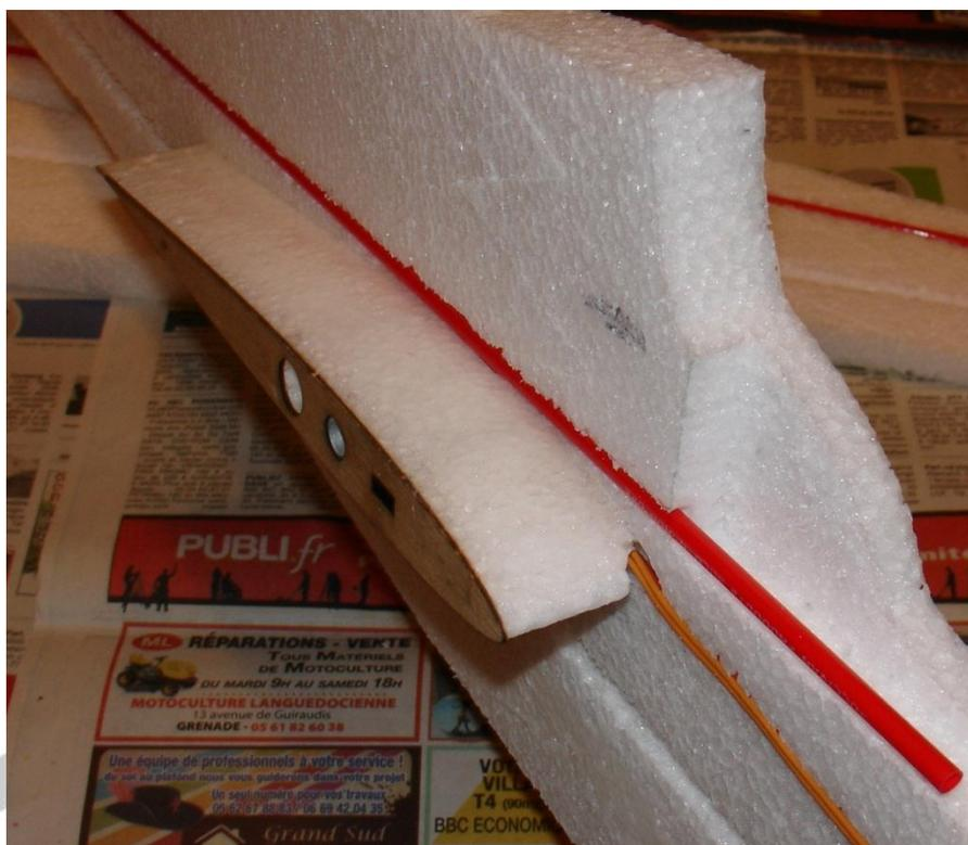
Dans la foulée, encoller l'une des faces en totalité, encoller la rainure du longeron des deux côtés et les rainures des gaines de commande. Mettre en place le longeron.
