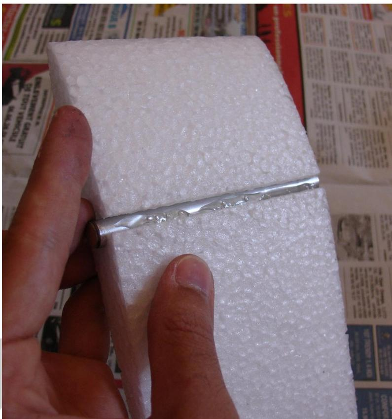
Coller les nervures à la colle à bois vinylique dans la foulée. Bien positionner le fourreau et brider le tout le temps du séchage. La fente va quasiment être bouchée par le gonflement de la colle polyuréthane.
