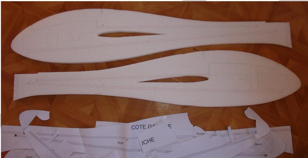
Fraiser ensuite les différents logements aux profondeurs indiquées sur le plan. Pour fraiser les logements des gaines de commande et du longeron du fuselage, mettre en place un guide pour fraiser bien droit.
