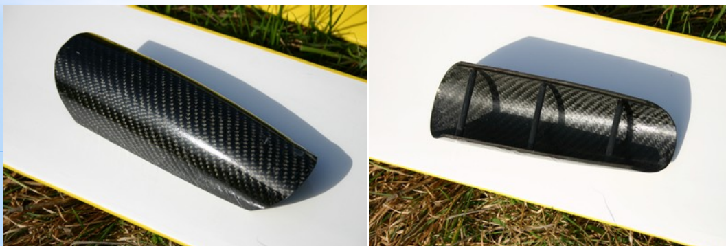
La bulle en bois est fabriquée en découpant le fuselage. Ici, l'auteur s'est fait plaisir en moulant par dessus la forme une verrière en carbone. Pour la rigidité, des tubes de carbone viennent la renforcer.
