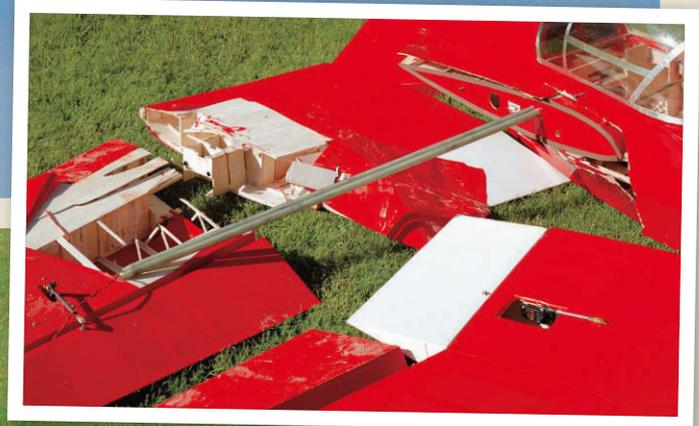
... der Flügel ist im Knick gebrochen, die Kohlefaserrohre sind zu kurz ausgelegt
