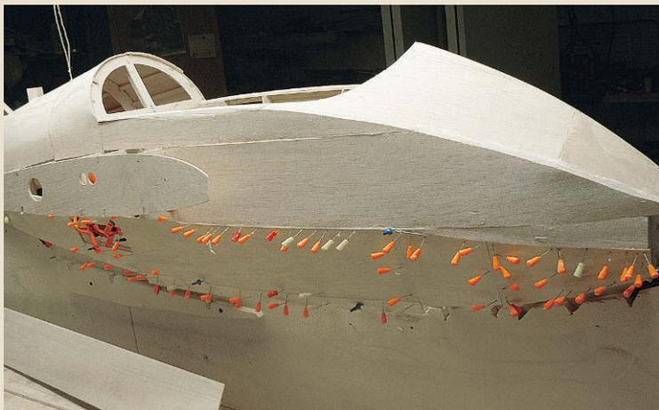
Die Rumpfbeplankung teils in größeren, teils in kleineren Vierecken
